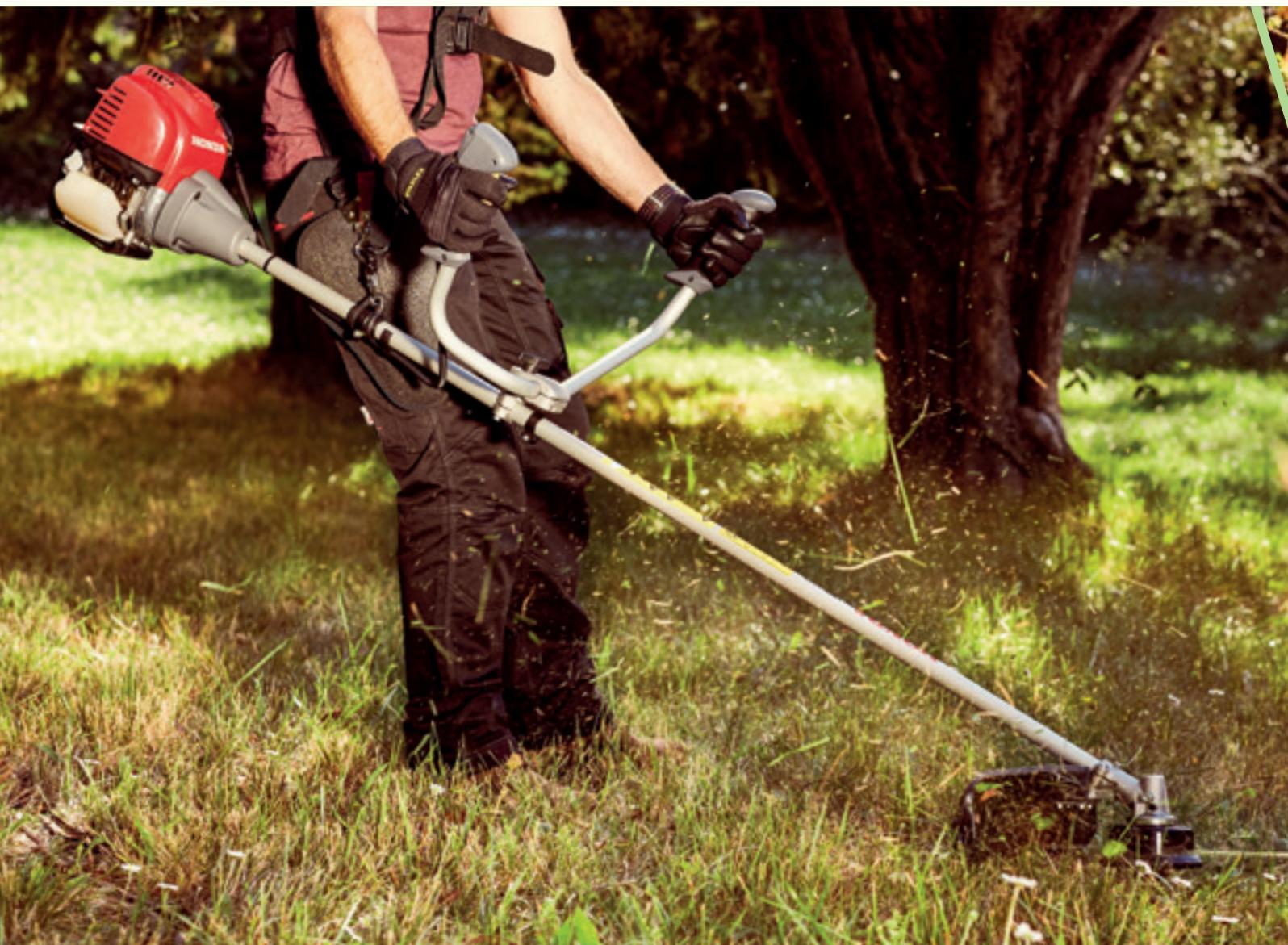
*Le système "Tap & Go" permet de réajuster automatiquement le fil lors de l'utilisation en frappant la tête faucheuse au sol*
