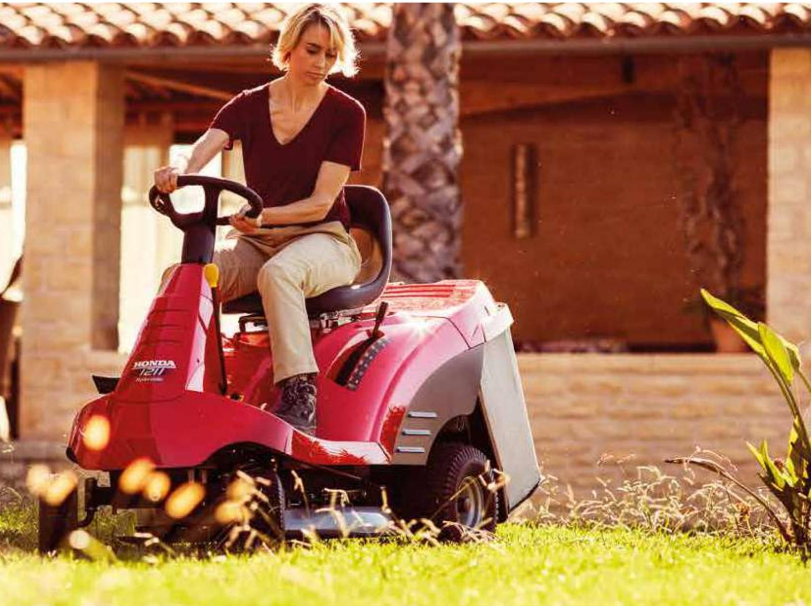
**Le HF 1211 est conçu pour les grands terrains. Il est très performant et maniable. Grâce à la transmission hydrostatatique et au levier de vidage du bac de ramassage, facilement accessible depuis le siège conducteur, la tonte est un jeu d'enfant.**
