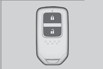
Utiliser les clés pour activer et désactiver le système d'alimentation, ainsi que pour verrouiller et déverrouiller toutes les portes, le hayon et la trappe à carburant.
