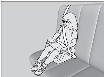
Si l'utilisation d'une ceinture de sécurité ventrale/thoracique ne convient pas, placer l'enfant dans un siège rehausseur sur le siège arrière. Pour la sécurité de l'enfant, s'assurer que l'enfant satisfait à l'ensemble des conditions du fabricant du siège rehausseur.
