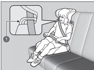
Un dossier est disponible pour certains sièges rehausseurs. Installer le dossier sur le siège rehausseur et le régler par rapport au siège du véhicule conformément aux instructions du fabricant. S'assurer que la ceinture est correctement passée dans le guide au niveau de l'épaule du dossier et qu'elle ne touche pas ou ne passe pas sur le cou de l'enfant.
