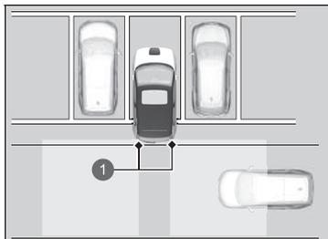
① Capteurs radar : sous les coins du pare-chocs arrière
