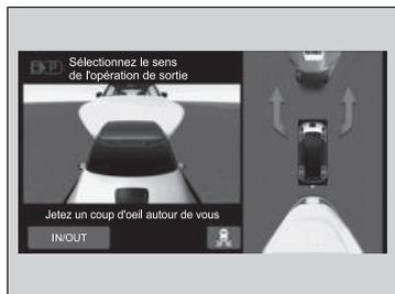
2. Appuyer et sélectionner le sens dans lequel l'écran va être déployé en enfonçant la pédale de frein.
