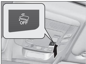
Il est possible d'armer le système de sécurité sans activer le capteur d'inclinaison.
