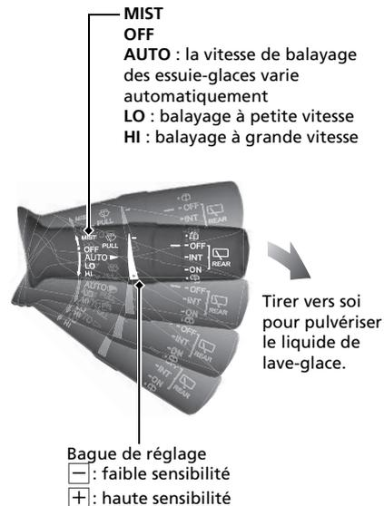
Le mode **AUTO** doit toujours être mis sur **OFF** avant les situations suivantes, pour éviter d'endommager sérieusement le système d'essuie-glace :
