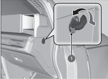
1 Commutateur **ON/OFF** de l'airbag avant côté passager
