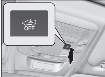
Il est possible d'armer le système de sécurité sans activer le capteur à ultrasons.
