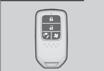
Utiliser les clés pour démarrer et arrêter le système d'alimentation, ainsi que pour verrouiller et déverrouiller toutes les portes, le hayon et le couvercle de charge.
