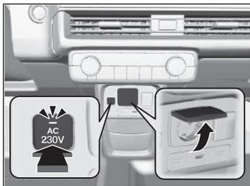
Ouvrir le couvercle pour y accéder. Brancher l'appareil, puis appuyer sur le bouton **AC 230V**.
