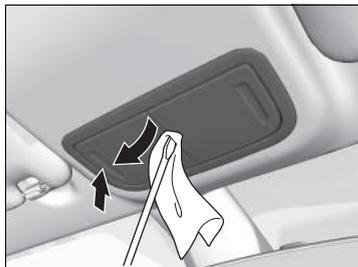
1. Faire lever sur le bord du cache à l'aide d'un tournevis à lame plate pour déposer le cache.
