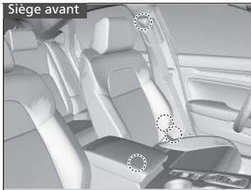
Lors du remplacement des ceintures de sécurité, utiliser les points d'ancrage représentés sur les figures.
