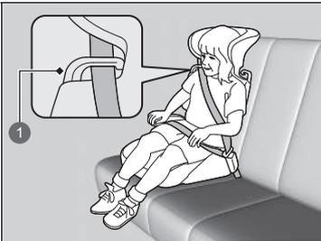
Un dossier est disponible pour certains sièges rehausseurs. Installer le dossier sur le siège rehausseur et le régler par rapport au siège du véhicule conformément aux instructions du fabricant. S'assurer que la ceinture de sécurité est correctement passée dans le guide au niveau de l'épaule du dossier et qu'elle ne touche pas ou ne passe pas sur le cou de l'enfant.
