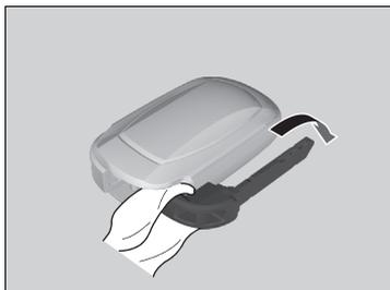
2. A l'aide d'un embout de clé, faire levier sur l'ouverture et déposer le demi-boîtier supérieur.
