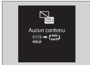
Permet d'afficher une autre unité sur l'interface d'information du conducteur et de régler les mesures affichées pour les lire en km et km/h ou en miles et mph.
