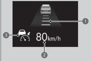
Lorsque l'ACC avec maintien de distance de sécurité à basse vitesse démarre, l'icône du véhicule, les barres d'intervalle et la vitesse réglée s'affichent sur la jauge.
