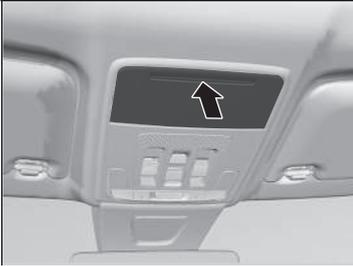
Pour ouvrir le porte-lunettes de soleil, appuyer sur le renforcement et le relâcher. Pour le fermer, appuyer de nouveau jusqu'à ce qu'il se verrouille.
