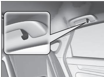
Des porte-manteaux sont montés sur les poignées de maintien arrière gauche et droite.
