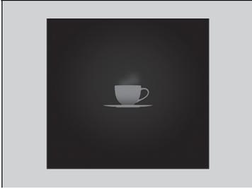
Si le nombre de barres chute à un, un signal sonore retentit, le volant se met à vibrer et la tasse à café devient orange pour avertir le conducteur qu'il a besoin de faire une pause car son niveau d'attention est trop bas.
