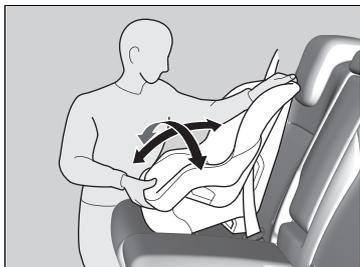
6. S'assurer que le dispositif de retenue pour enfant est fermement maintenu en le faisant basculer d'avant en arrière et d'un côté à l'autre ; il ne doit présenter que peu de jeu.
