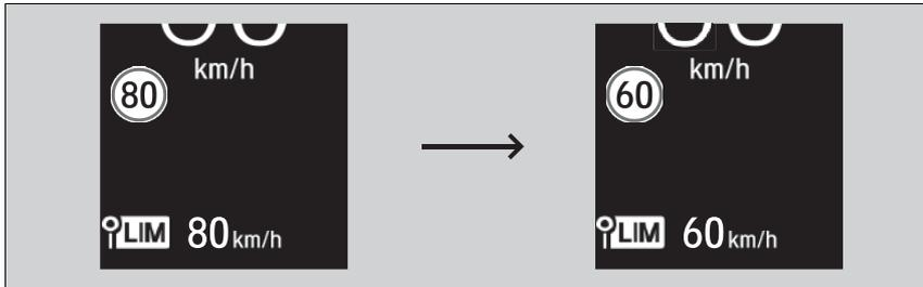
■ **Les fonctions de limitation de vitesse et d'avertissement peuvent passer en mode pause s'il n'y a pas de panneau de signalisation de limite de vitesse sur l'écran du système de reconnaissance des panneaux de signalisation (TSR) lorsque :**
